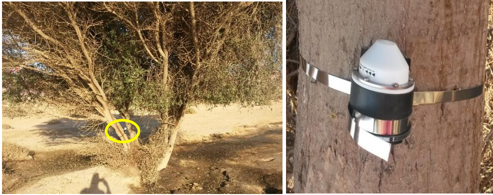
איור 3: גזע שעליו הותקן דנדורמטר אלקטרוני אוגר נתונים (ימין - מבט מקרוב, שמאל מבט כללי, הדנדורמטר מוקף בצהוב).
