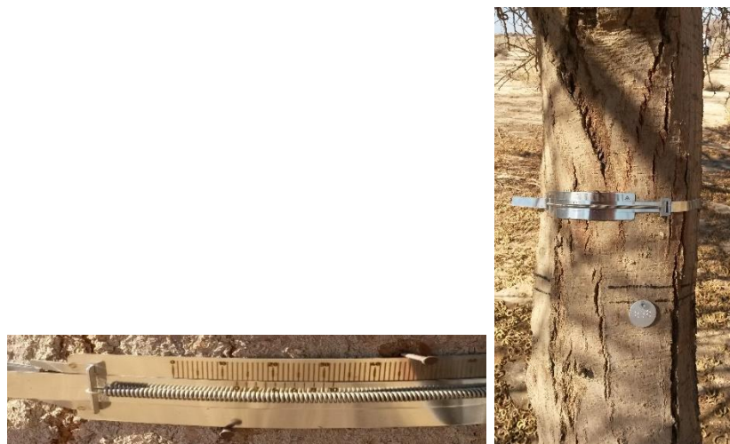
איור 2: גזע שעליו נמדד היקף בעזרת סרט ידני, וסומן בצבע שחור, ומעליו מותקן דנדרומטר ידני (מימין), ומבט מקרוב למנגנון פעולת הדנדרומטר הידני (משמאל).
