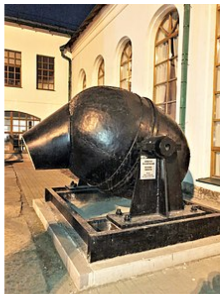
Модель бессемеровского конвертера Нижнесалдинского завода (XIX в.) в экспозиции музея УрГАХУ в Екатеринбурге
